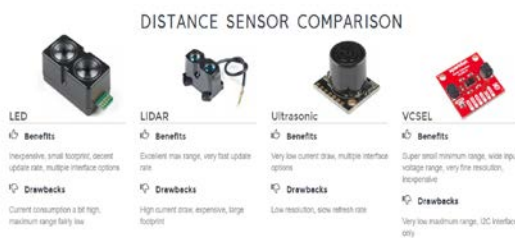
รูปที่ 3.1 เปรียบเทียบเซนเซอร์วัดระยะ (Distance Sensor)
